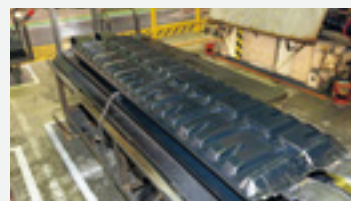
SCS式は1度目の加硫後、向きを変えて再度加硫する
