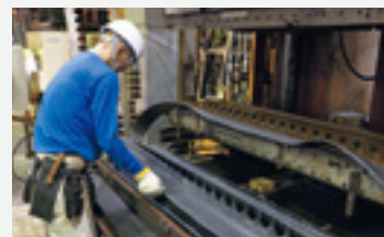
治具を外した後、その他の部材をセット
